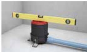
I vantaggi di questo nuovo scarico doccia si notano già dall'installazione: fissaggio stabile al pavimento grezzo tramite viti e piedini in acciaio inox insonorizzati, la regolazione delle viti di fissaggio permette al corpo di scarico di essere dotato già della pendenza necessaria per il collegamento con il tubo di scarico.
